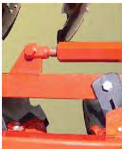
Регулирование угла атаки борны
